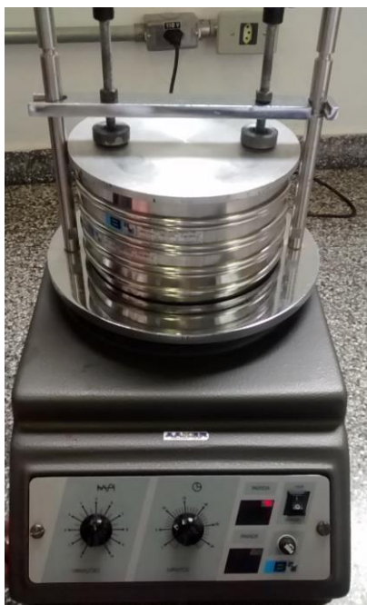
Fotografia 3 - Agitador de peneiras para análises granulométricas eletromagnético.
