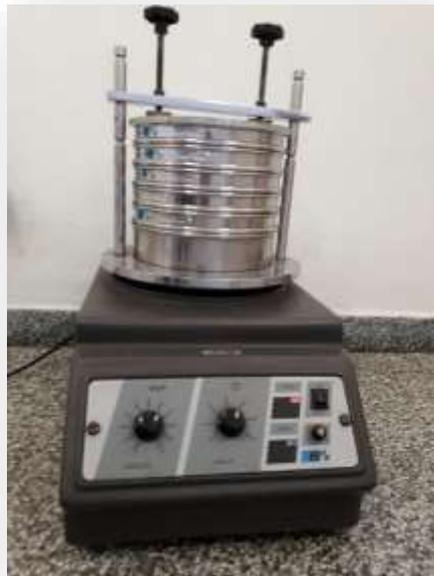
**Fotografia 1 - Agitador Eletromagnético com Peneiras Redondas (Bertel – AAKER).**
