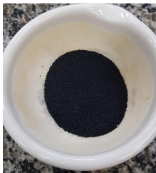
Figura 17 - Material seco macerado após rotoevaporação
