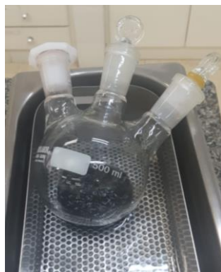
Figura 14 - Solução de óxido de cobalto e etanol absoluto em banho ultrassônico
