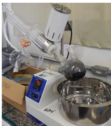
Figura 16 - Material no rotoevaporador
