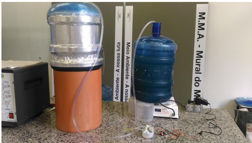
Figura 11 - RALF e componentes em operação para o tratamento de esgoto
