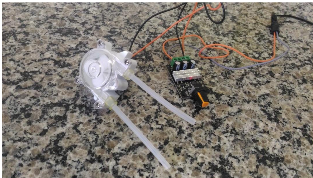
Figura 10 – Instalação da bomba peristáltica e módulo PWM para transporte do efluente
