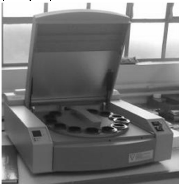
Figura 12 – Espectômetro de fluorescência de raios-X por dispersão de energia, MiniPal 4 (PANalytical).
