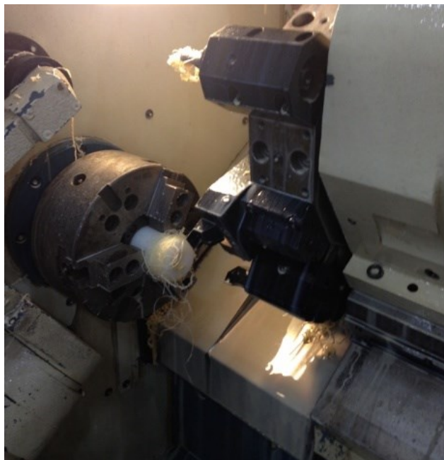
Figura 9 – Anéis de fixação sendo fabricados no centro de usinagem CNC da UTFPR- Câmpus Ponta Grossa.
