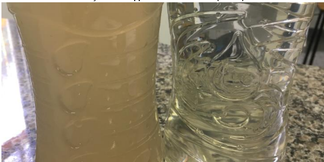
Figura 7 – Diluição do efluente bruto (esquerda) e diluição do efluente tratado com adição de 200 ppm de cloreto férrico (direita).
