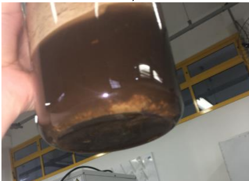
Figura 11 – Flocos depositados no fundo do béquer após decantação (experimento com 20 V).
