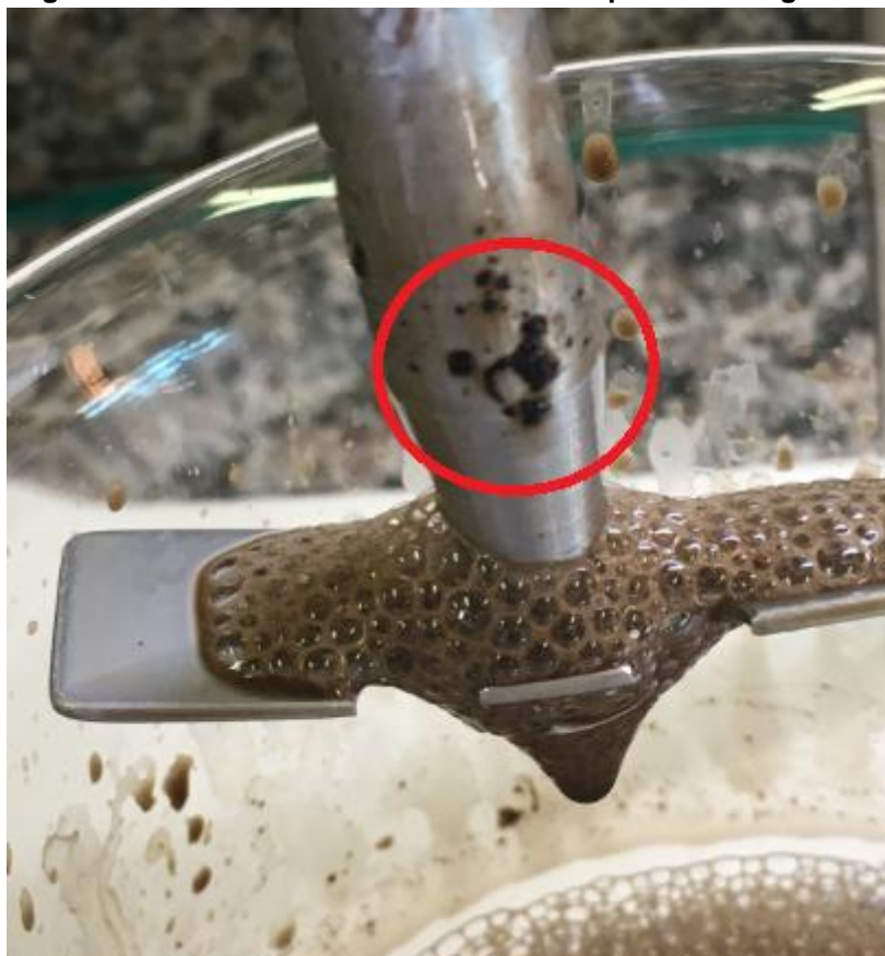
Figura 6 – Cloreto férrico acumulado na superfície do agitador.
