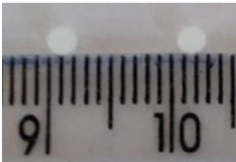
Figura 13 - Esferas de \text{TiO}_2 imobilizado em alginato
