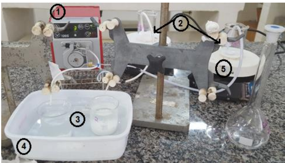
Figura 11 - Sistema para a produção das esferas de catalisador composto por: bomba peristáltica (1), béquer com a solução de alginato e \text{TiO}_2 (2), béquer com \text{CaCl}_2 na recepção das esferas (3), banho termostático (4) e agitador magnético (5)
