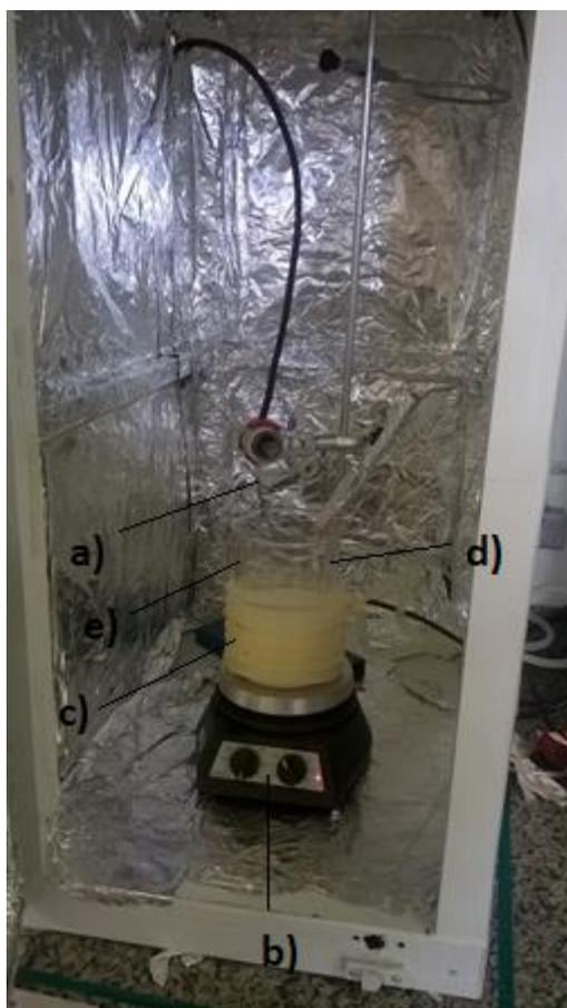
**Figura 12 – Sistema para fotocatalise: a)-Lâmpada; b)- agitador magnético; c)-mangueira para temperatura; d)- mangueira para aeração; e) reator**
