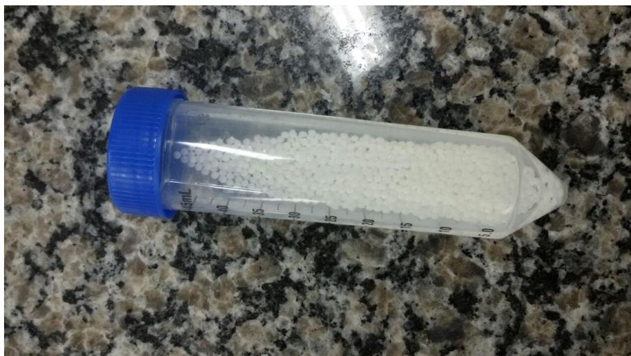
Figura 8 – Fotocatalisador TiO<sub>2</sub> imobilizado em esferas de alginato
