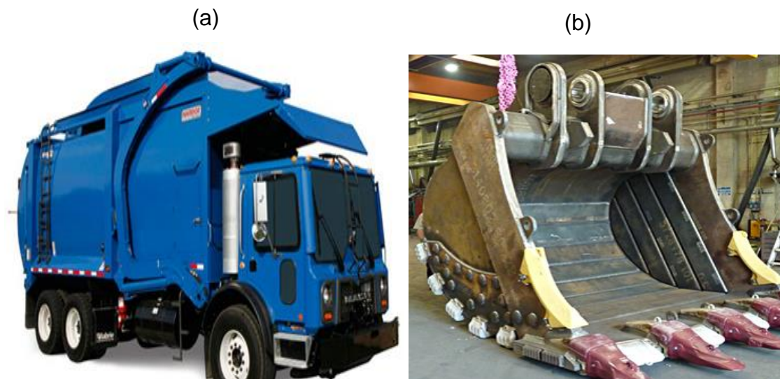
Figura 1- Exemplos de aplicações dos aços Hardox®: (a) carroceria de caminhões de lixo e (b) peça para máquinas de mineração e pedreira
