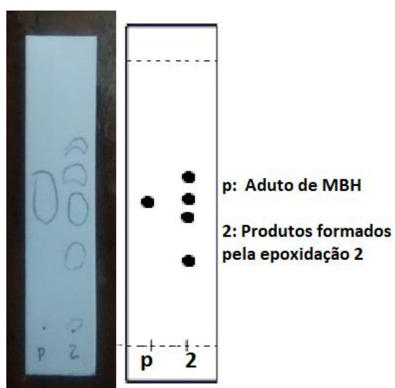
Figura 22 – Placa CCD Padrão vs Reação 2.
