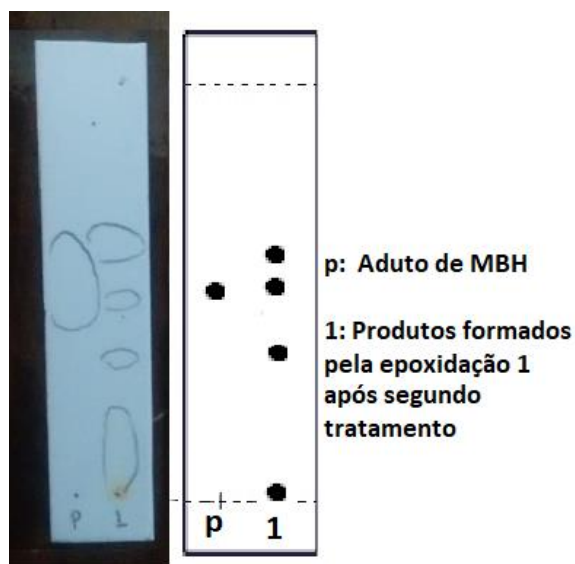
Figura 39 - Placa CCD Padrão vs. Reação 1 Fonte: Autoria própria
