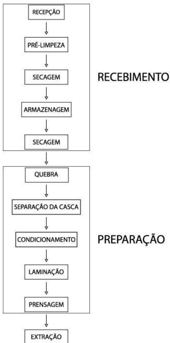
Figura 1 - Fluxograma do Processamento da Soja
