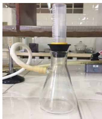
Figura 7 - Sistema de filtração acoplado ao kitassato.
