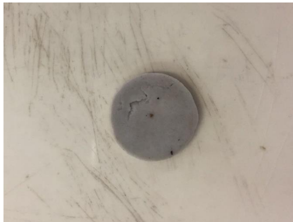
Figura 8 – Membrana produzida com sal Mesh 150 após lixamento.
