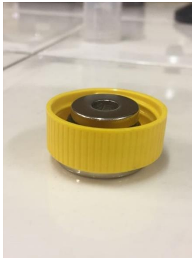
Figura 11 –Tampa do tubo Falcon com o ímã de neodímio
