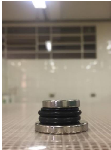
Figura 13- Anéis de vedação compactados.
