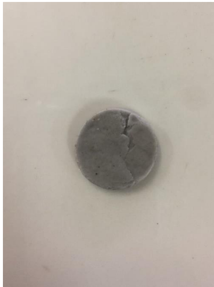
Figura 9 – Membrana produzida com sal Mesh 250 após lixamento.
