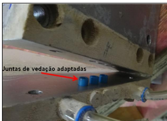
Fotografia 10 – Juntas de vedação adaptado no bloco de válvulas Fonte: Autoria própria
