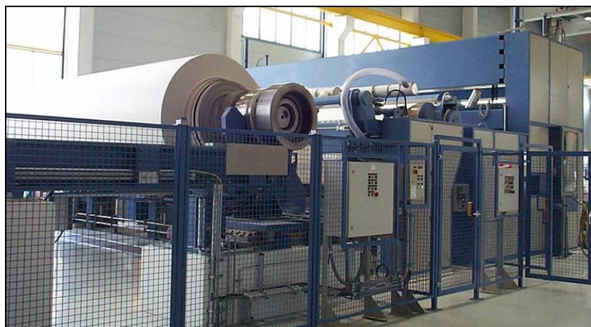
Fotografia 2 – Desenrolador de rolos jumbo Fonte: Autoria própria
