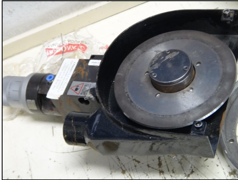
Fotografia 4 – Faca circular montada em pistão pneumático Fonte: Autoria própria
