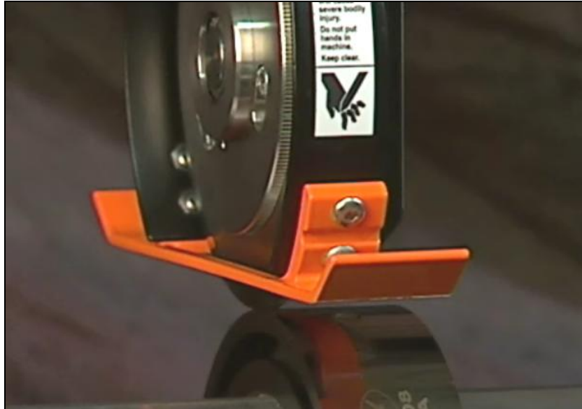
Fotografia 7 – Aprofundamento da faca na contra faca Fonte: Autoria própria
