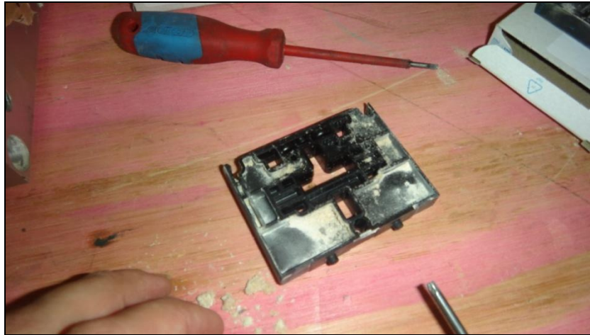
Fotografia 8 – Válvula direcional em manutenção Fonte: Autoria própria
