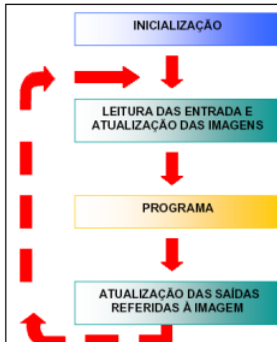
Figura 2 - Ciclo de processamento do CLP
