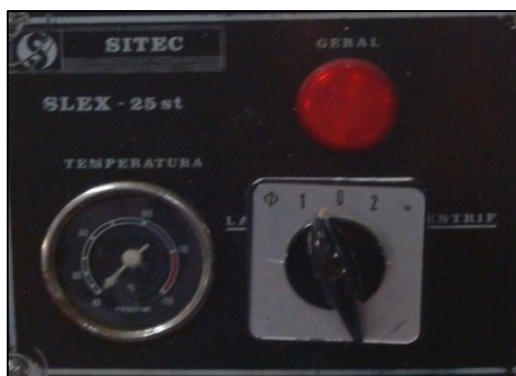
Fotografia 6: Chave de seleção dos ciclos Fonte: Autoria própria
