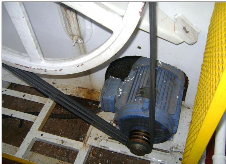
Fotografia 3: Motor de 10CV, 1760RPM instalado Fonte: Autoria própria
