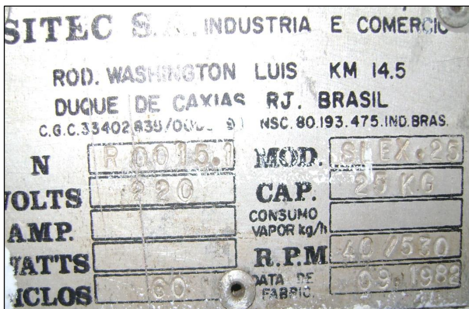
Fotografia 2: Placa de identificação da máquina de lavar roupa Fonte: Autoria própria
