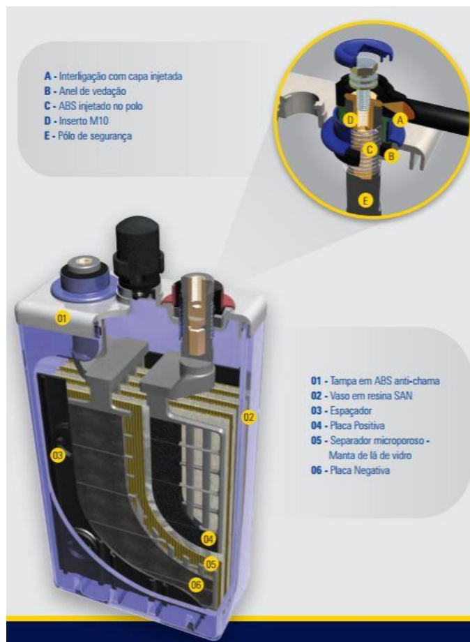
Figura 2: Vista das partes construtiva de um acumulador de carga
