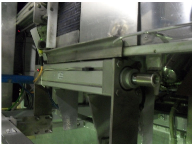
Figura 62: Foto pistão pneumático com sensores de fim de curso Fonte: Autoria própria
