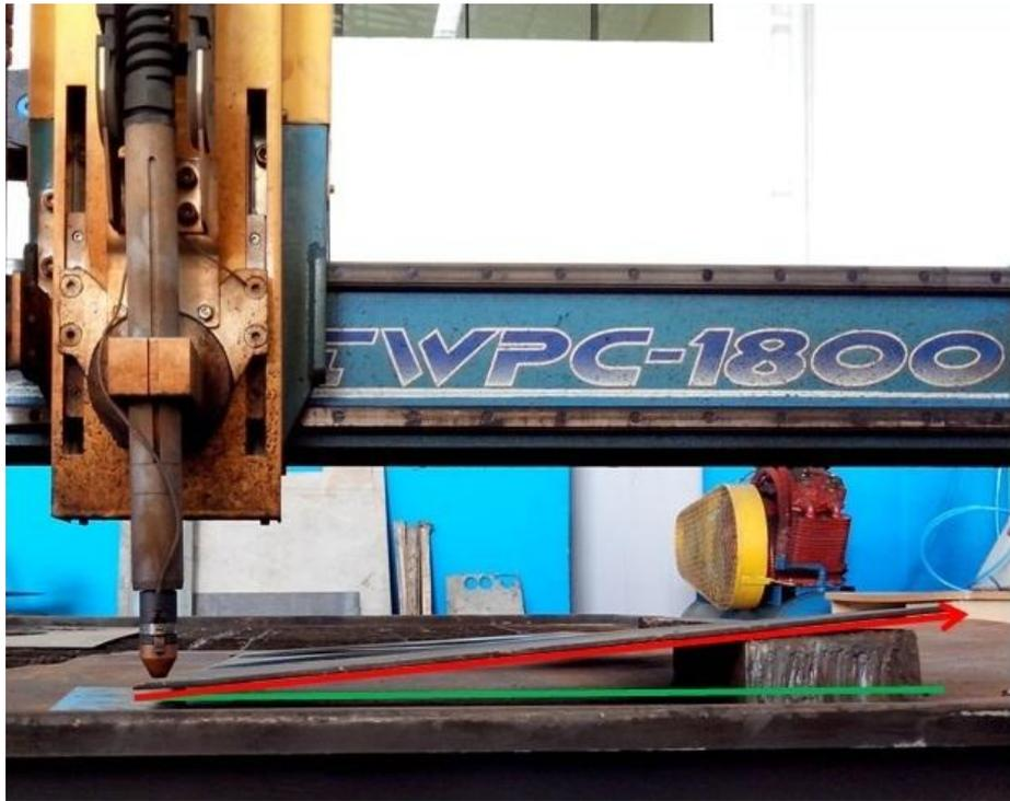
**Figura 23: Corte linear em sentido inverso.**
