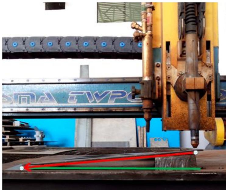
**Figura 22: Simulação da Tocha iniciando através do ponto superior.**
