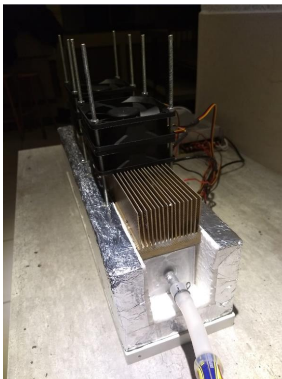
Figura 19 - Protótipo dois com os dissipadores de potência.
