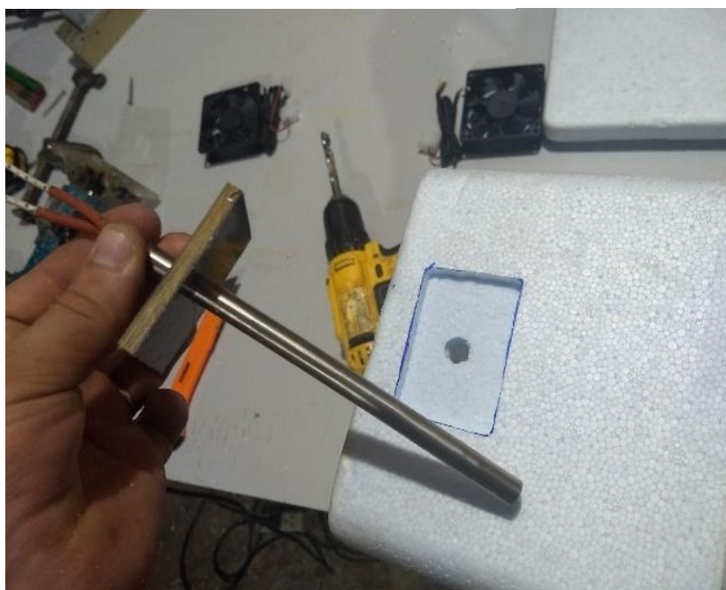
Figura 11 - Montagem da resistência
