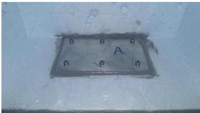
Figura 10 - Dissipador de alumínio fixado na caixa de isopor.
