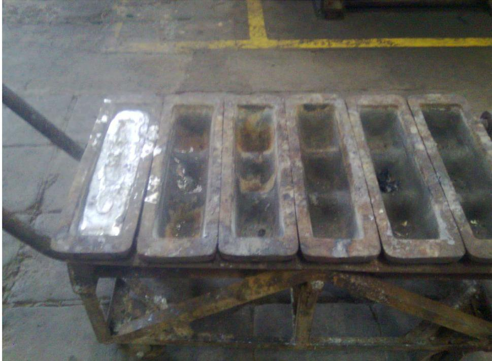
**Figura 10- Lingote de metal patente a base de estanho (ASTM B23 liga 2).
