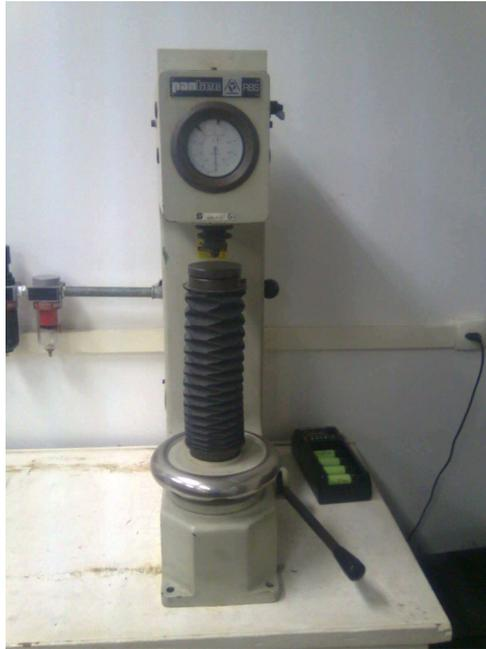
**Figura 16 - Durômetro Pantec.**
