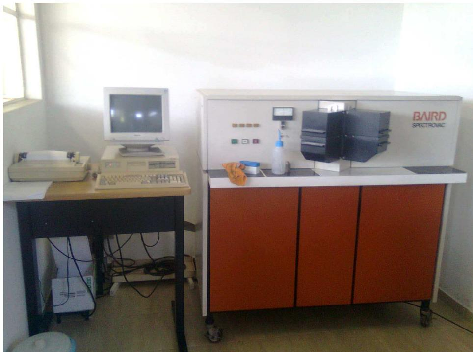
**Figura 17- Espectrômetro Baird.**
