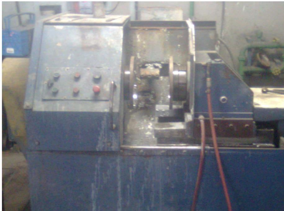
**Figura 30- Metalização por Centrifugação dos Anéis.**
