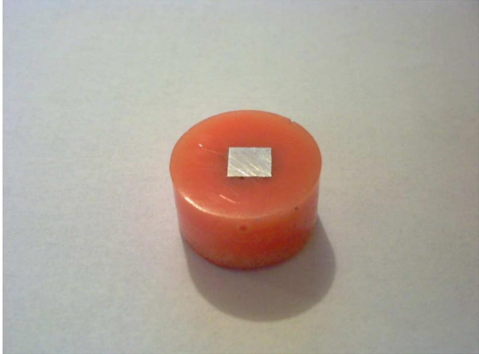
**Figura 25- Foto da amostra pronta para análise microscópica.
