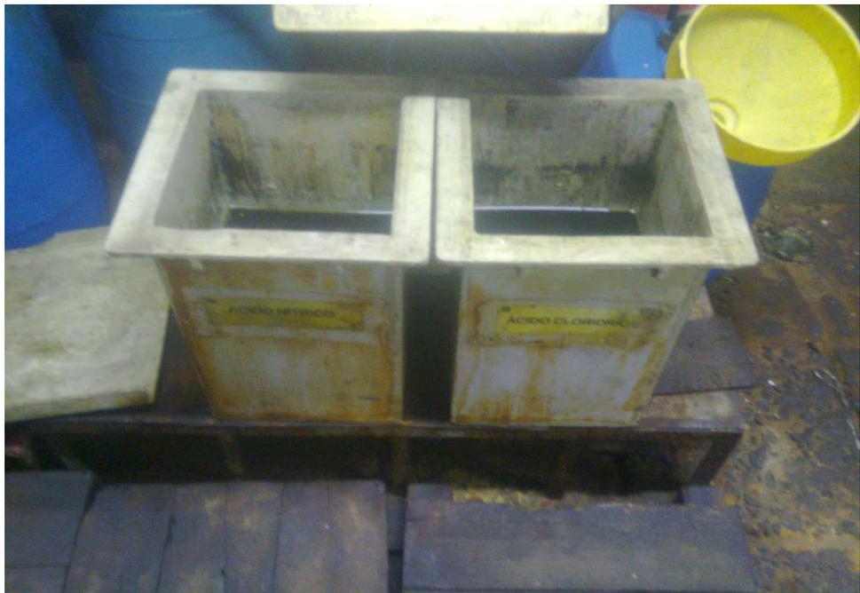
**Figura 11- Tanques de Ácido Clorídrico e Ácido Nítrico.
