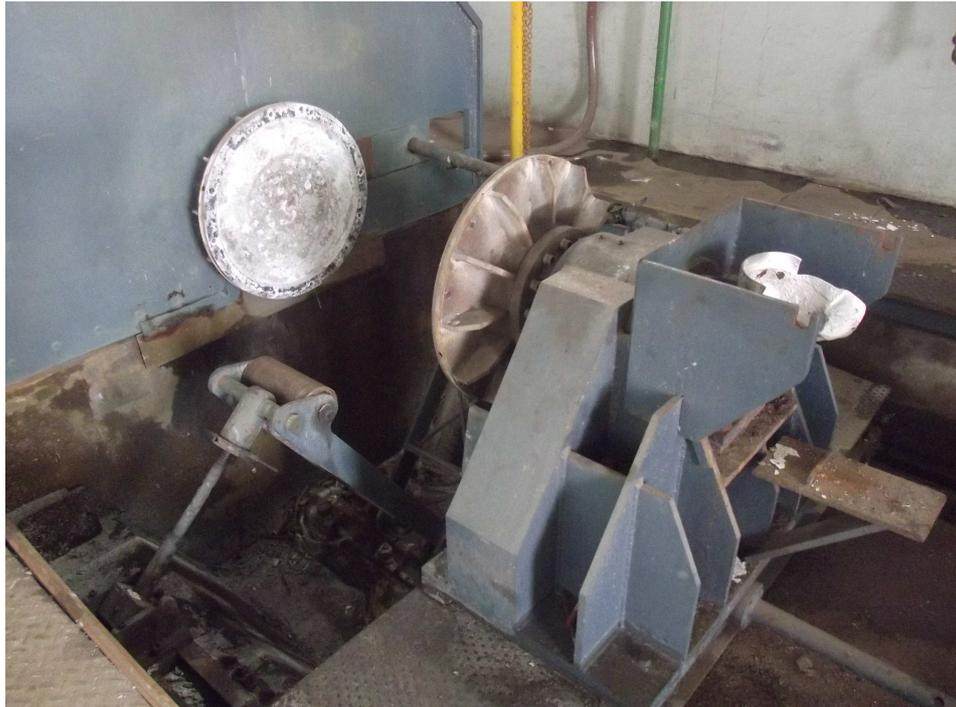
**Figura 8- Sistema para metalização por centrifugação.**
