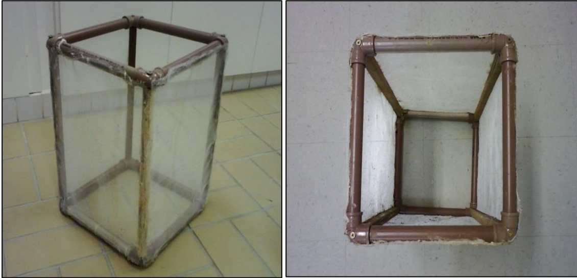
FIGURA 21. Vista geral e superior do amostrador para macrófitas aquáticas constituído de PVC e nas laterais malha de 1mm. Fonte: autor
