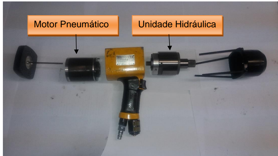
Figura 2 – Apertadeira Hidropneumática, motor mais unidade hidráulica Fonte: Autoria própria
