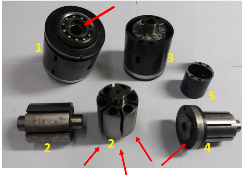
Figura 6 –Componentes do motor pneumático Fonte: Autoria própria
