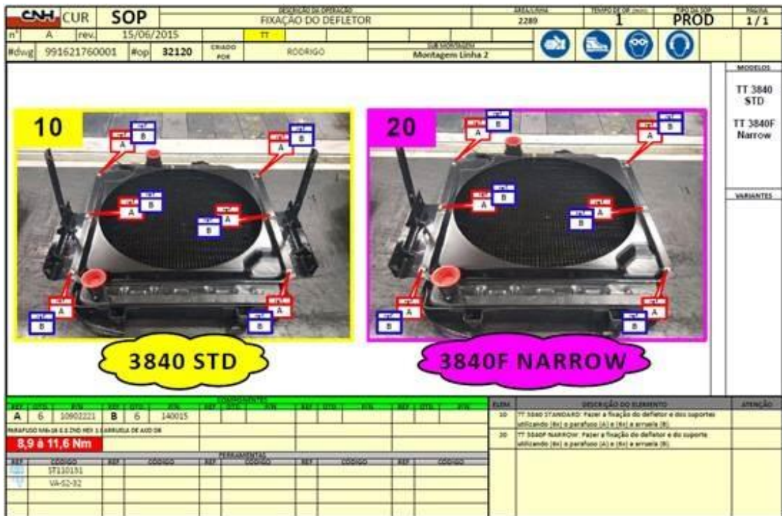
Figura 33 – Processo da montagem do defletor do radiador Fonte: Cortesia CNH industrial
