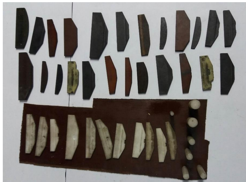
Figura 7 – Imagem mostra as palhetas do motor Fonte: Autoria própria
