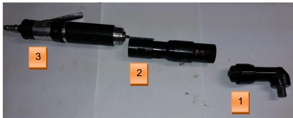
Figura 11 – Imagem mostra uma apertadeira em 3 partes Fonte: Autoria própria
