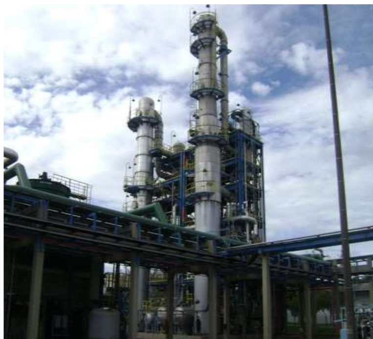
Figura 2 - Colunas de destilação para a concentração de H_2O_2 Fonte: Acervo da Peróxidos do Brasil Ltda.
