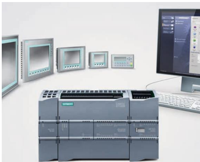
Figura 11: CLP SIMATIC S7 - 1200 Fonte: Siemens (2015).
