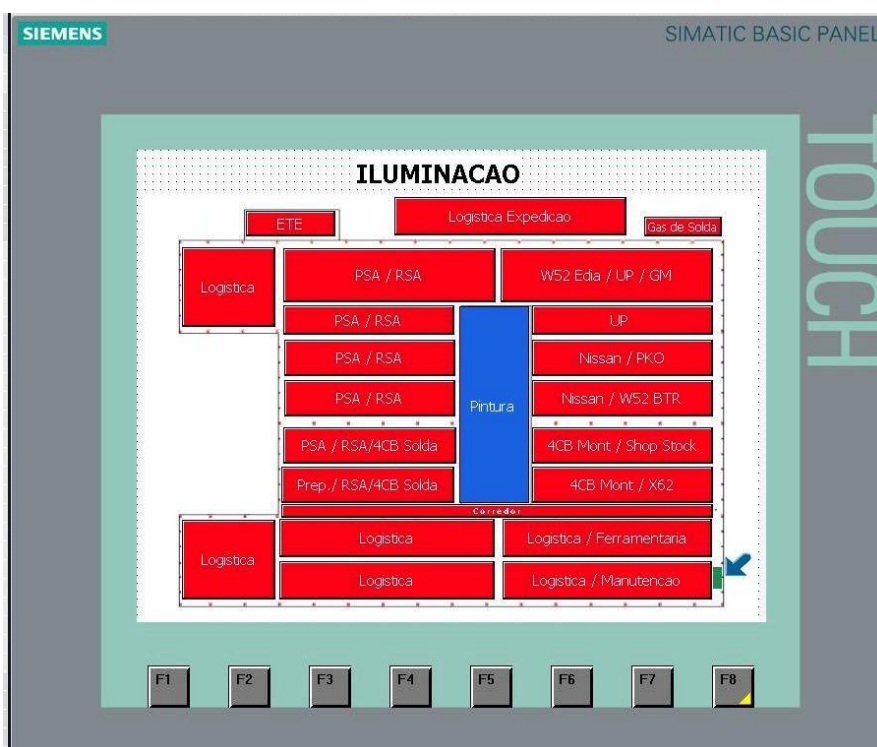
Figura 17: Tela da IHM no modo iluminação Fonte: Autoria própria.
