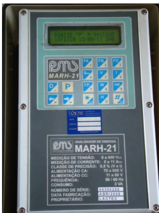
Figura 10 – Analisador de Potência MARH-21. Fonte: Autor
