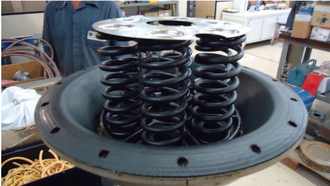
Figura 33 - Molas do atuador da válvula globo. Fonte: A autoria própria.
