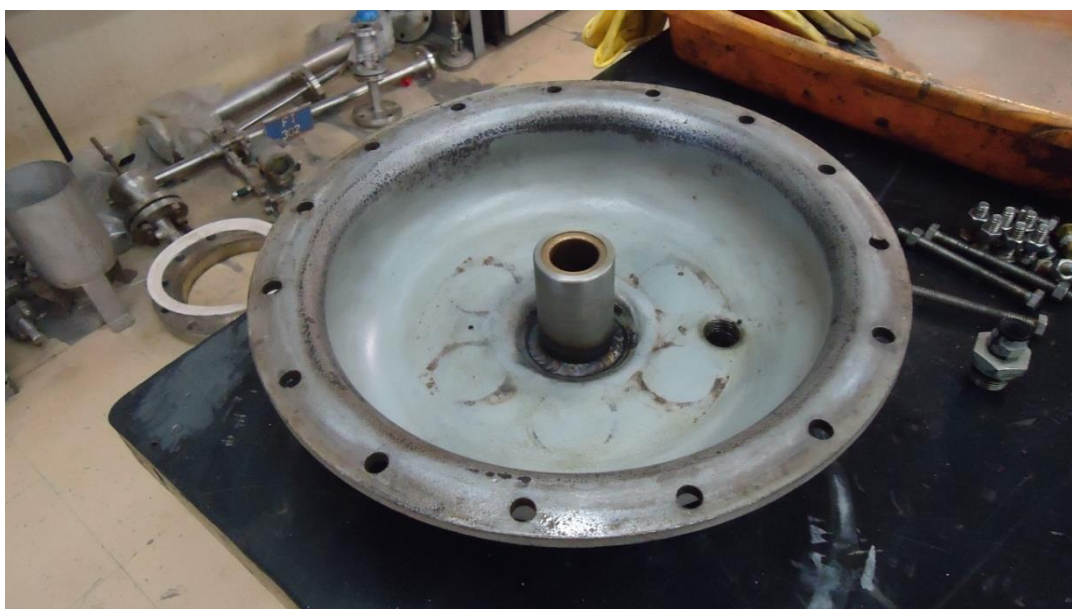
Figura 32 - Guia com embuchamento de bronze instalado no prato do atuador. Fonte: Aatoria própria.
