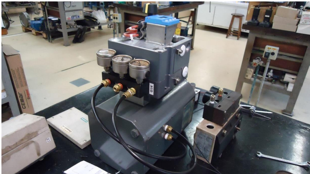
Figura 17 - Posicionador ND9000 no atuador de dupla ação da válvula borboleta. Fonte: Autoria própria.
