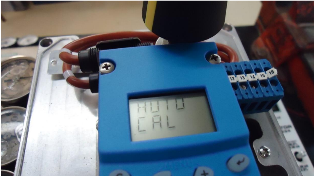
Figura 18 - Posicionador em processo de auto calibração. Fonte: Autoria própria.
