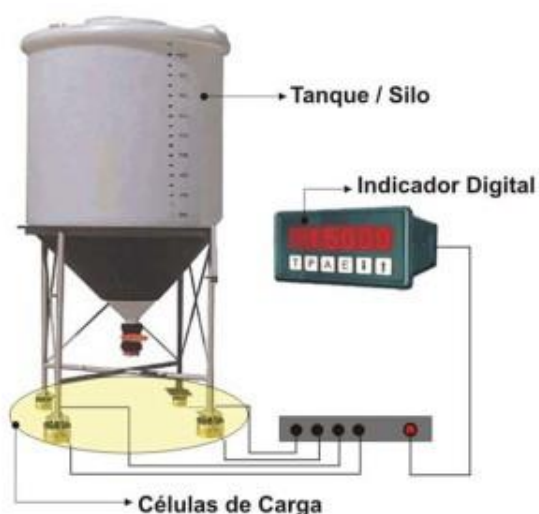
Figura 6 – Dispositivo de pesagem tipo células de carga
