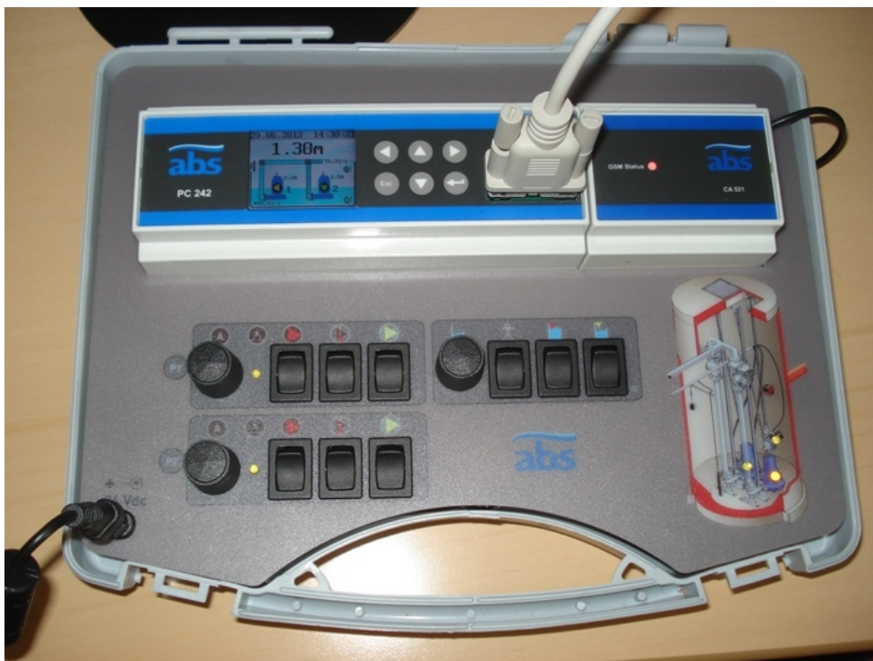
Figura 3.6 – Controlador de bombas ABS PC 242 em caixa de simulação de sinais. Fonte: Autoria própria
