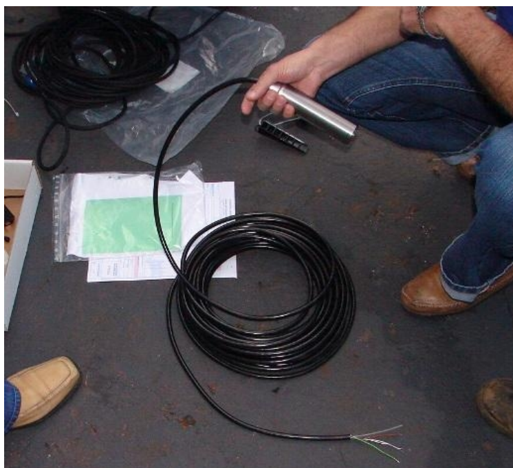
Figura 3.4 – Sensor de nível hidrostático. Fonte: Autoria própria
