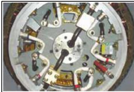
Figura 6 – Roda de diodos da excitatriz de um motor do tipo brushless . Fonte: ELETROMOTORES WEG 4 (20--).
