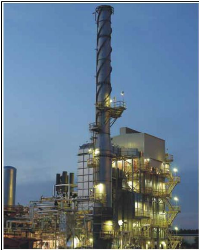
Figura 42 – Exemplo de forno reformador real aplicado ao setor petroquímico. FONTE: Confab Industrial S.A. (2010).
