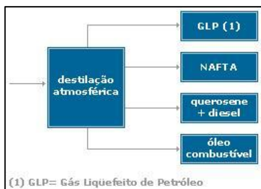
Figura 37 – Processo de destilação atmosférica – início dos processos modernos. FONTE: ANP 2 .
