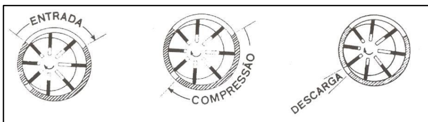
Figura 28 – Representação do ciclo de compressão do compressor de palhetas.
