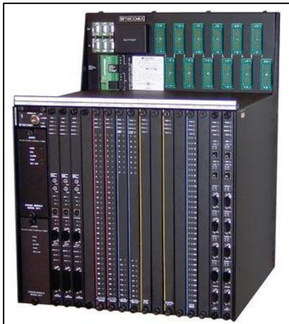
Figura 51 – Equipamento aplicável em um SIS. FONTE: Invensys Inc, 2012.
