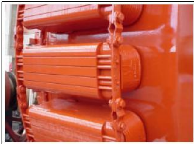
Figura 2 – Enrolamento amortecedor de um rotor com pólos salientes. Fonte: ELETROMOTORES WEG 1 (19--).
