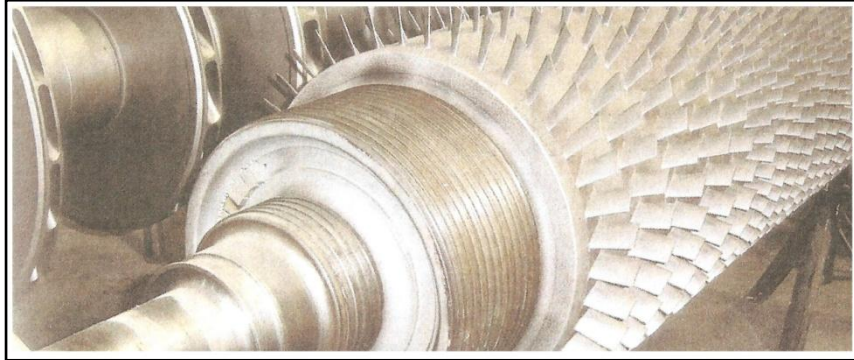
Figura 33 – Exemplo de rotor utilizado em compressor axial. FONTE: NÓBREGA, 2011, p. 33.
