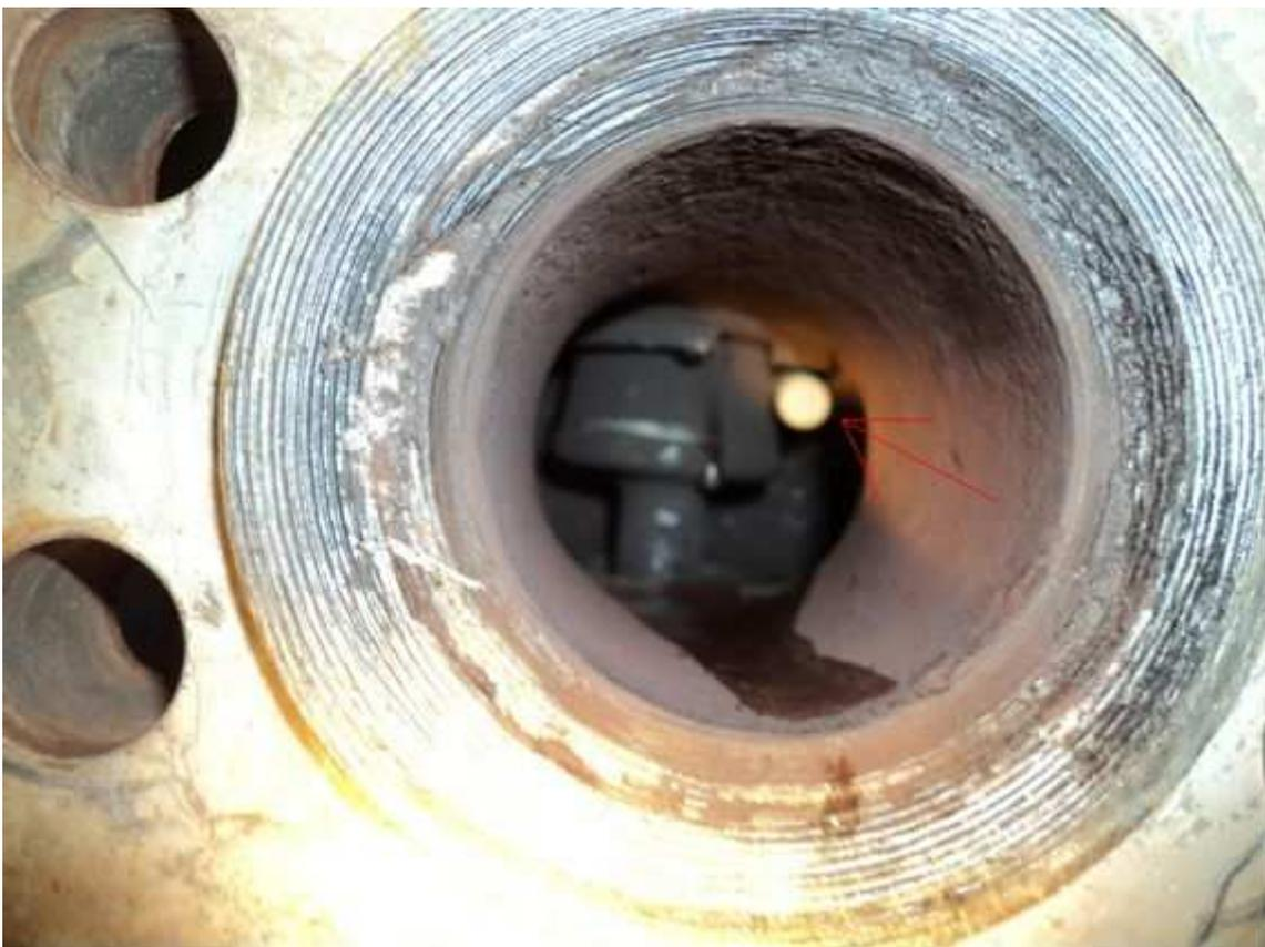
Figura 14: Objeto metálico incrustado no interior de válvula de controle
