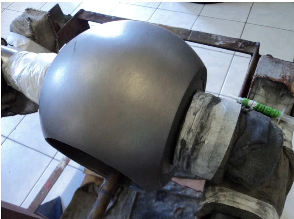
Figura 9: Manutenção em válvula esfera, 8 polegadas, 600#, vedação metal-metal.
