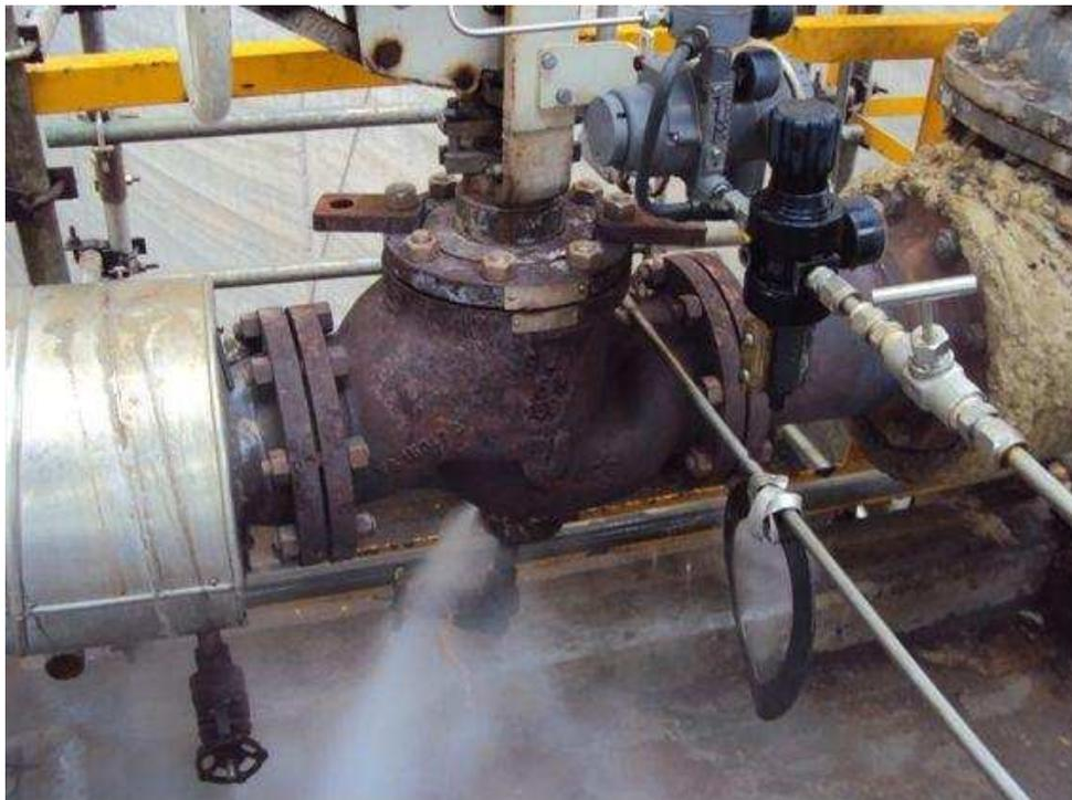
Figura 10: Erosão causada pela cavitação em válvula globo
