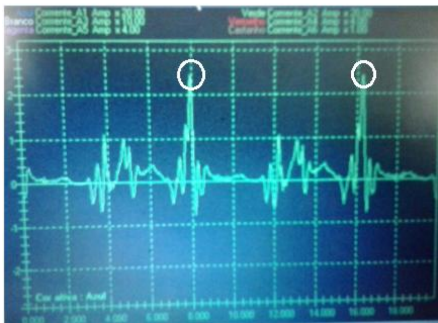
Gráfico 10 – Monitoramento de Corrente Eixo A2 Fonte: Autoria Própria (Abcissa= 2 segundos por divisão; Ordenada= 20,0 Ampères por divisão)
