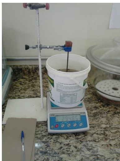
Figura 5 - Determinação da densidade da madeira pelo método de imersão em água.
