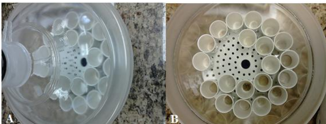
Figura 7 - Cadinhos secos dentro do dessecador (A), cadinhos após a queima das amostras (B)
