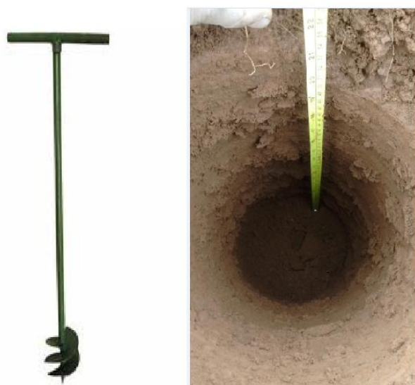
Figura 2 - Trado de perfuração do solo e Ponto de perfuração para coleta de solo
