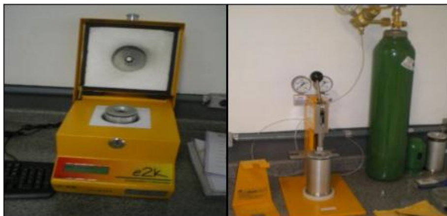
Figura 8 - Bomba Calorimétrica utilizada para, determinar poder calorífico.
