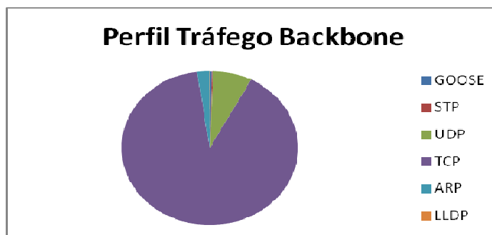
Figura 39: Composição média do tráfego das interfaces com backbone.
