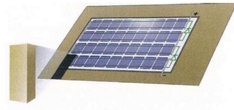
Figura 10: Sombreamento de uma célula FV dentro de um módulo FV.
