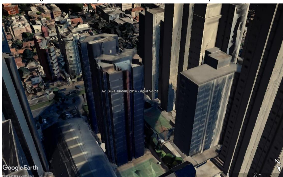
Figura 19 - Simulação de sombreamento na edificação às 18:00h
