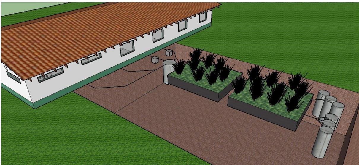
**Figura 11 - Ilustração representando uma proposta de disposição de um sistema de tratamento de esgoto envolvendo dois *wetlands* construídos em série**
