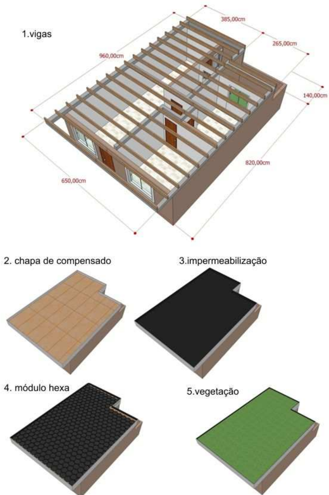
Figura 14. Composição do telhado verde sistema hexa.
