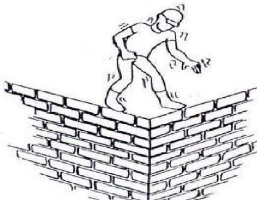
FIGURA 7- CAUSA DE QUEDAS: MÉTODO INCORRETO DE TRABALHO Fonte: ROQUE (2011).
