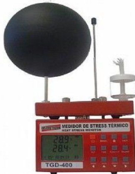
Figura 4- Medidor de Stress Térmico Digital com função de Anemômetro Fonte: Instrutherm, 2015
