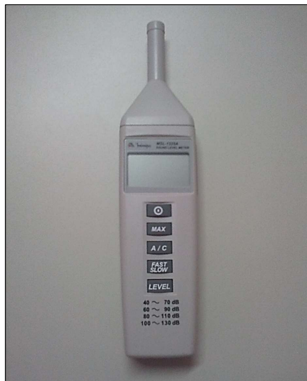
Figura 16 – Medidor de pressão sonora utilizado para a avaliação do nível de ruído
