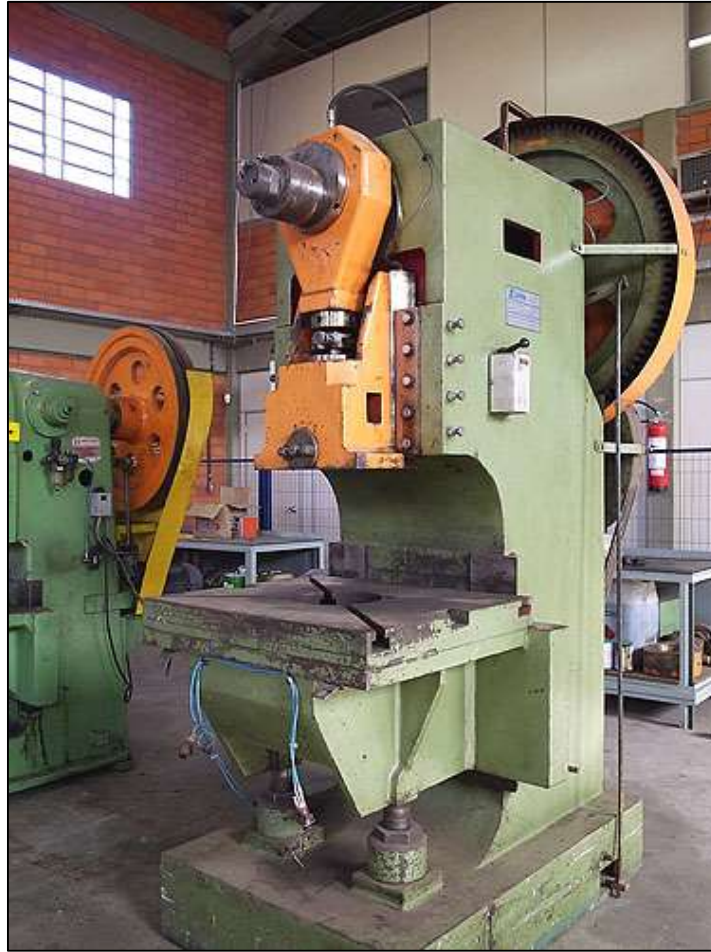
Figura 2 – Prensa mecânica excêntrica de engate por chaveta com zona de prensagem totalmente desprotegida
