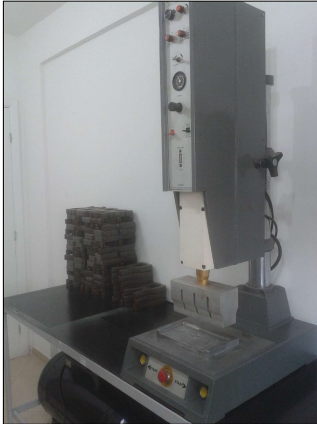
Figura 1 – Máquina de soldagem por ultrassom do tipo prensa
