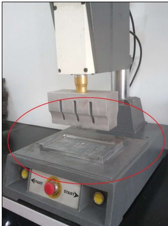
Figura 21 – Zona de prensagem (destacada em vermelho) totalmente desprotegida
