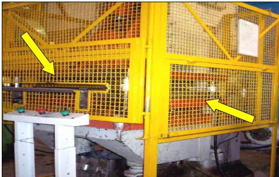
Figura 8 – Prensa enclausurada por proteções fixas, com apenas uma abertura para a colocação de materiais
