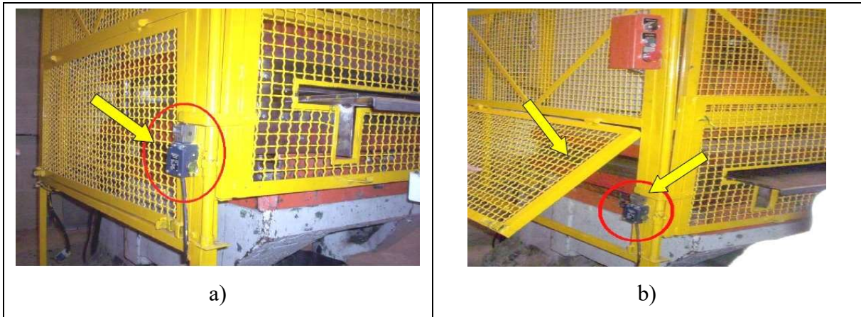
Figura 10 – Enclausuramento da zona de prensagem por proteção móvel com dispositivo de intertravamento: a) proteção móvel fechada; e b) proteção móvel aberta
