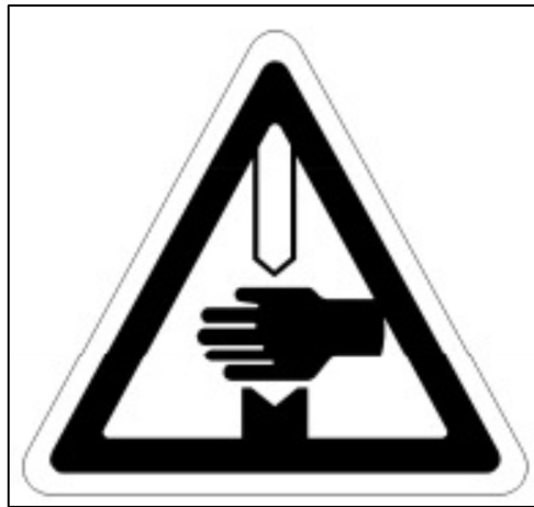
Figura 12 – Exemplo de sinalização que representa o risco de esmagamento das mãos Fonte: ABIMAQ, 2012.
