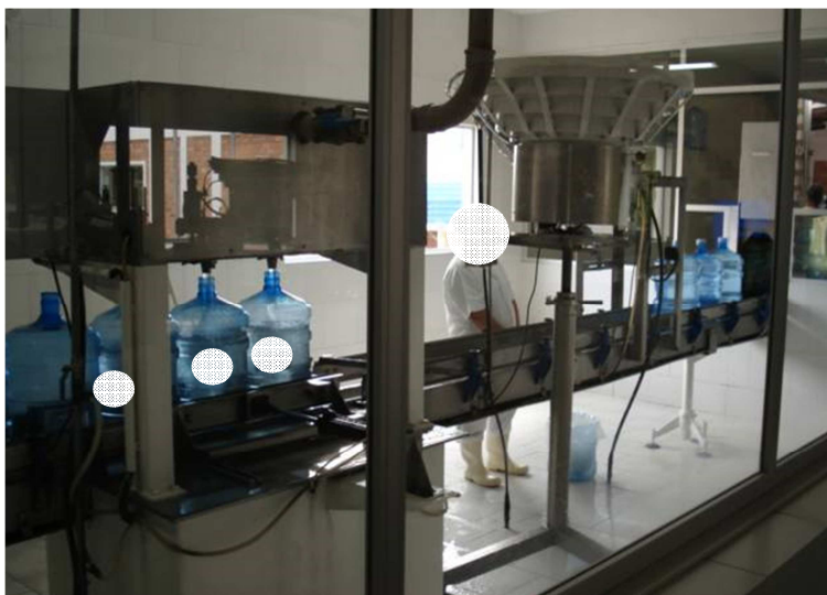
Figura 5 – Detalhe do enchimento e tamponamento automático de garrações retornáveis de 20 litros, realizado dentro da sala de envase. Fonte: Acervo do Autor.
