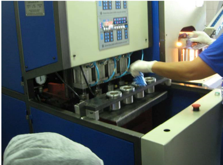
Figura 12- Equipamento de sopro com alimentação manual das pré-formas. Fonte: Acervo do Autor.
