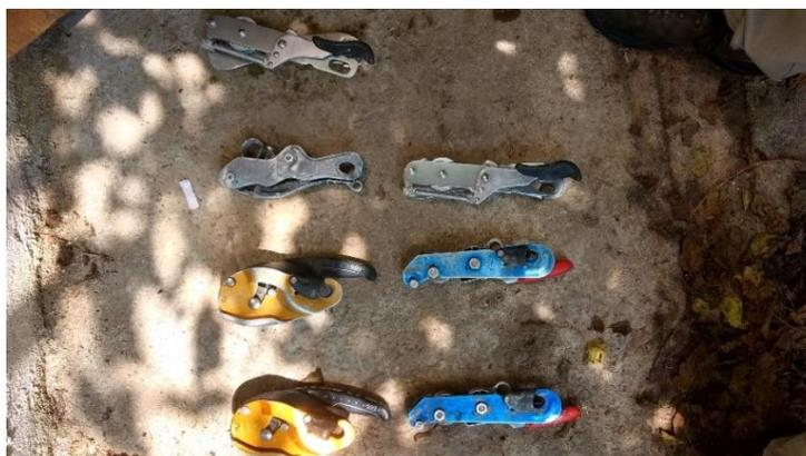
Figura 24 - Equipamentos descensores
