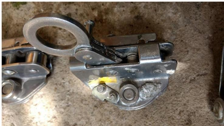
Figura 23 - Trava-quedas com residuo de material
