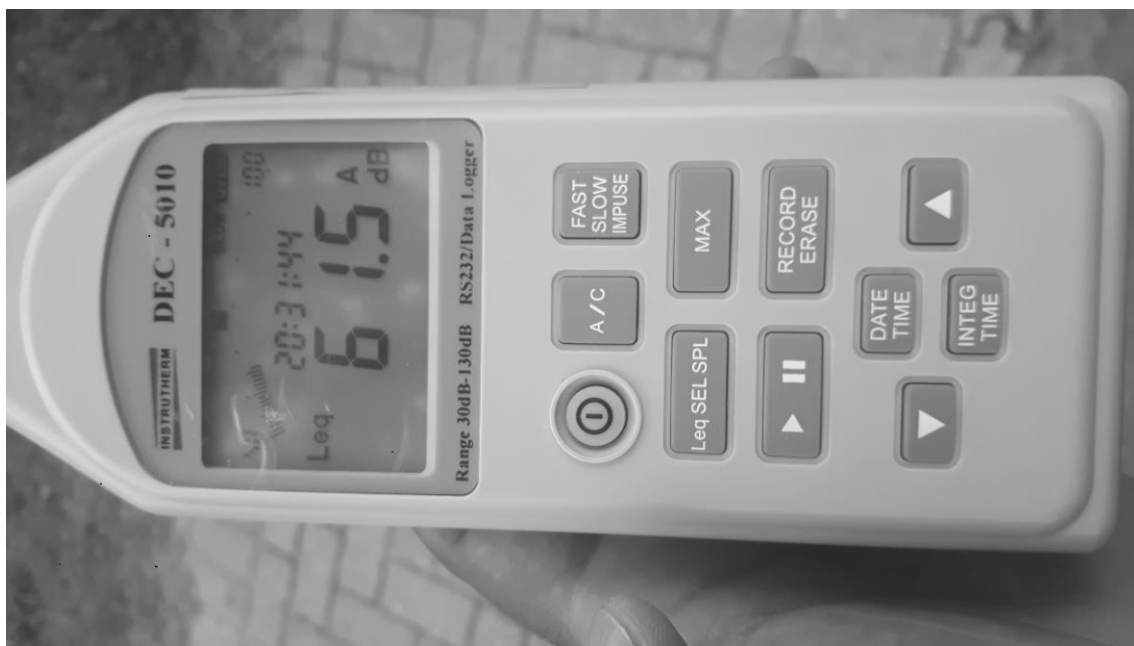
Foto 01- Medidor de nível de pressão sonora, marca Instrutherm, modelo DEC 5010.
