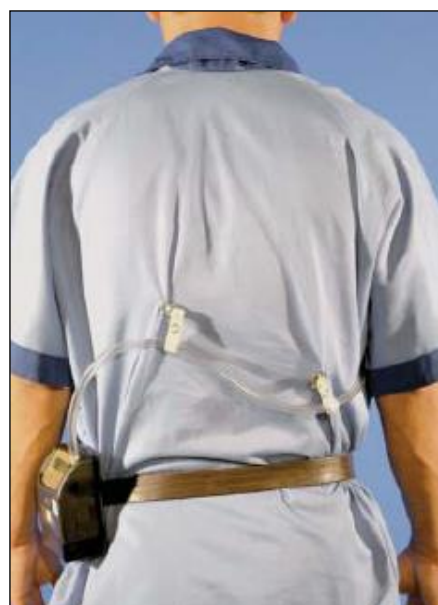
Figura 4 - Posicionamento do sistema de coleta individual costas. (Fonte: NHO 08, 2007))
