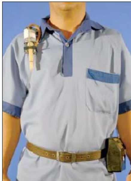
Figura 3 - Posicionamento do sistema de coleta individual frente. (Fonte: NHO 08, 2007))
