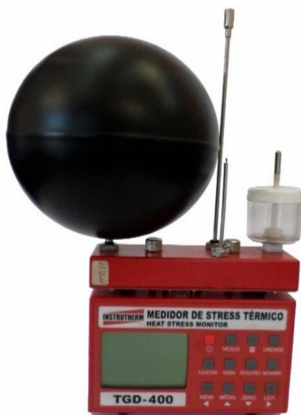
Figura 4 - Medidor de Stress Térmico. Fonte: acervo do autor
