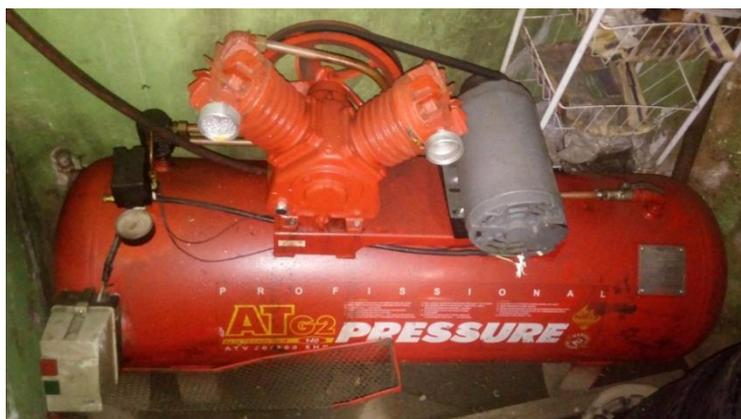
Figura 16 - Vaso de pressão empresa “B” (compressor de ar)
