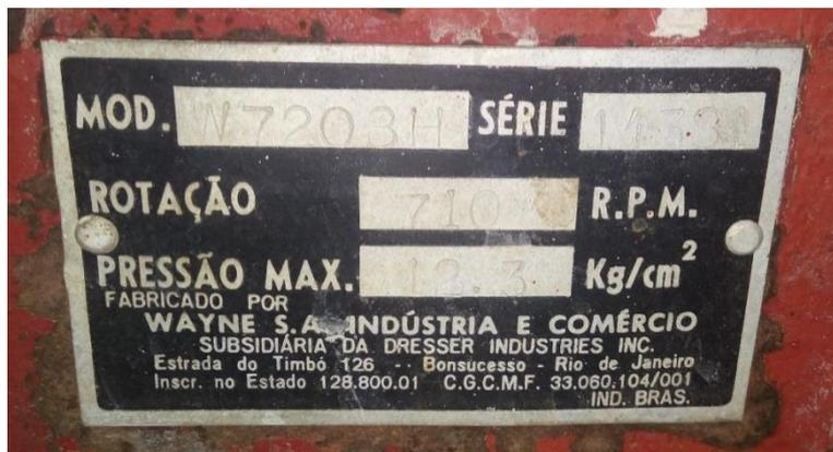
Figura 15 - Plaqueta de identificação do 2º vaso de pressão da empresa “A”
