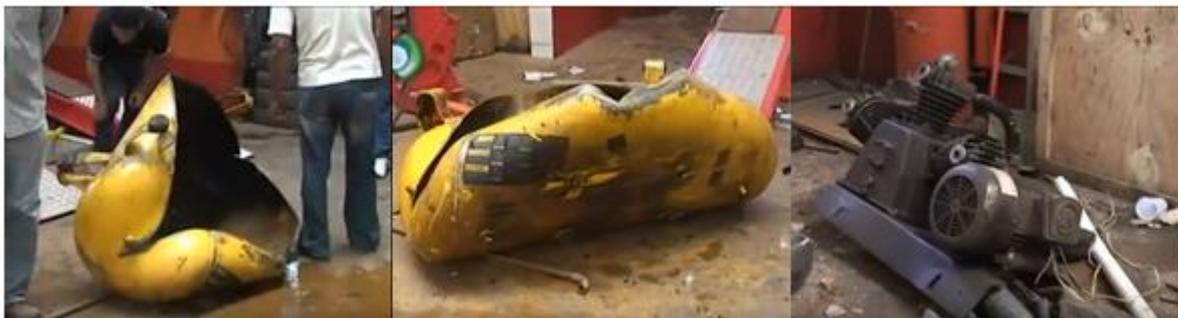
**Figura 01 - Compressor de ar após explosão**
