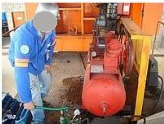
**Figura 03 - Teste hidrostático em um compressor**
