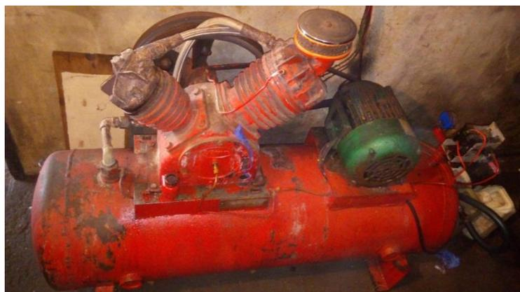
Figura 14 - 2º vaso de pressão da empresa “A” (compressor de ar)
