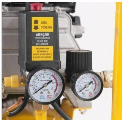
**Figura 06 - Manômetro analógico de compressor**
