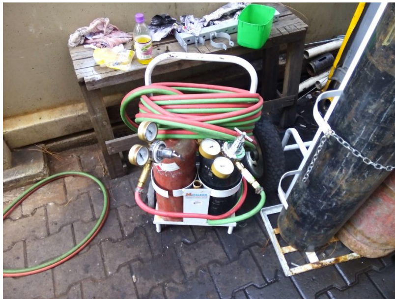
Figura 4 - Conjunto oxiacetilênico armazenado de maneira inadequada.
