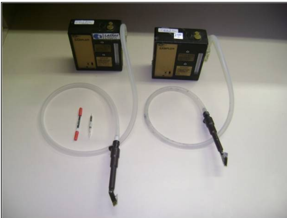
Figura 7—Imagem do equipamento bomba de vazão Fonte: Acervo do Autor (2013)
