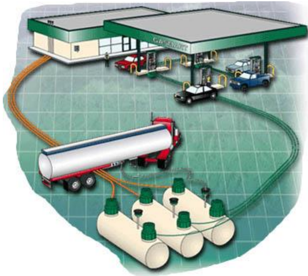
Figura 2 – Tubulações entre ponto de descarga e unidades abastecedoras. Fonte: Thomé Petróleo (2013).
