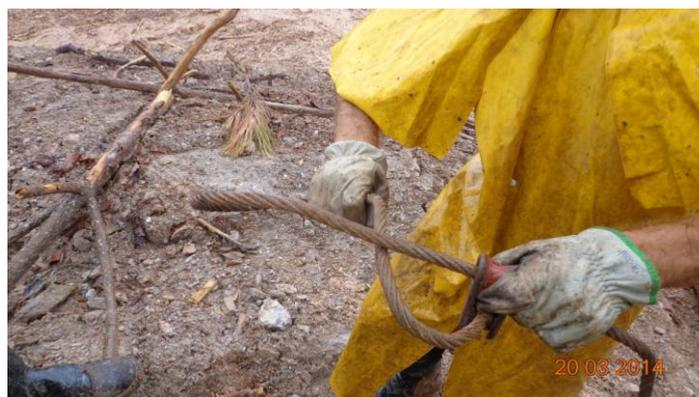
Figura 12. Cabo de aço utilizado no engate das toras
