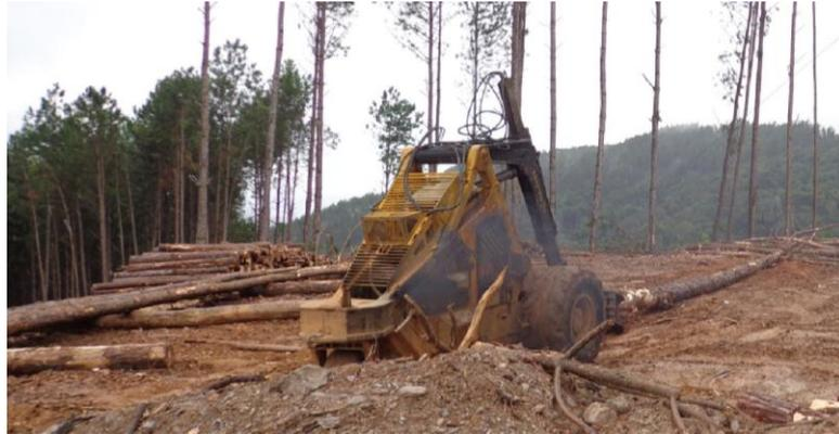
Figura 13. Operação com carregador florestal trineumático
