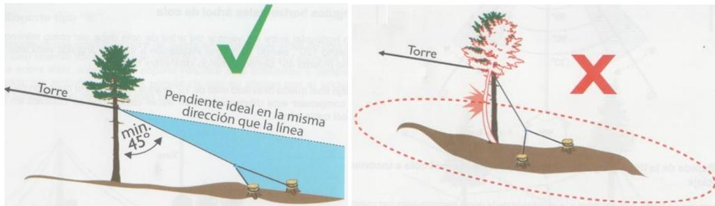
Figura 07. Ângulo entre árvore suporte e ponto de ancoragem final
